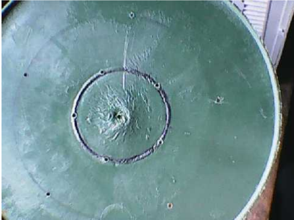
4. Bentuk lubang untuk penyiraman rintik-rintik
