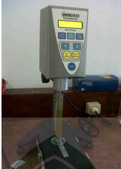
Gambar 5. Pengujian Viskositas Sediaan Gel
