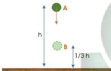
Sebuah benda jatuh bebas dari posisi A seperti pada gambar di atas. Hitunglah perbandingan energi potensial dan energi kinetik ketika sampai di B !
