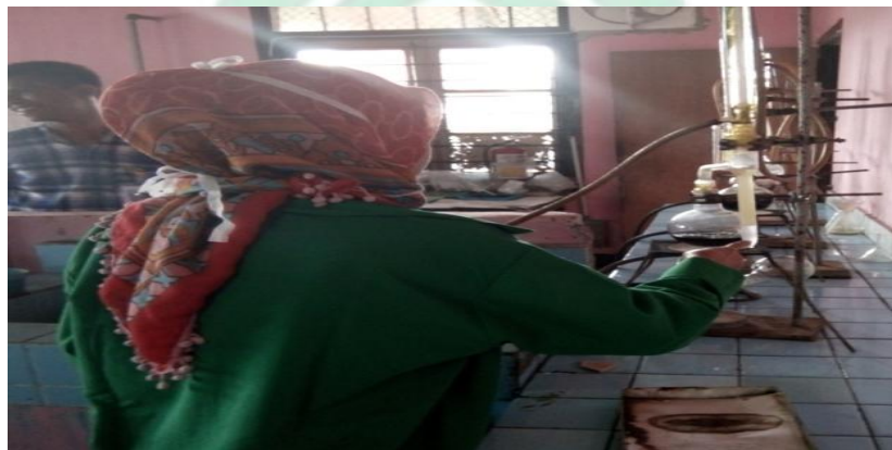
Proses ekstraksi kadar air setelah memasukkan larutan xylol ( C_8H_{10} )
