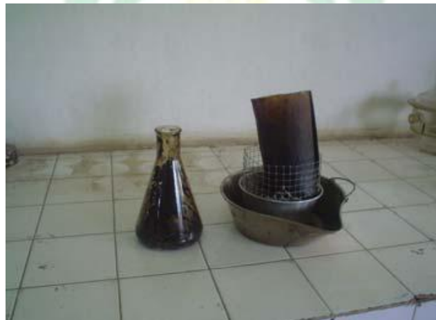
Gambar 2.6 Pengujian kelarutan bitumen dari asbuton butir (Affandi, 2008).
