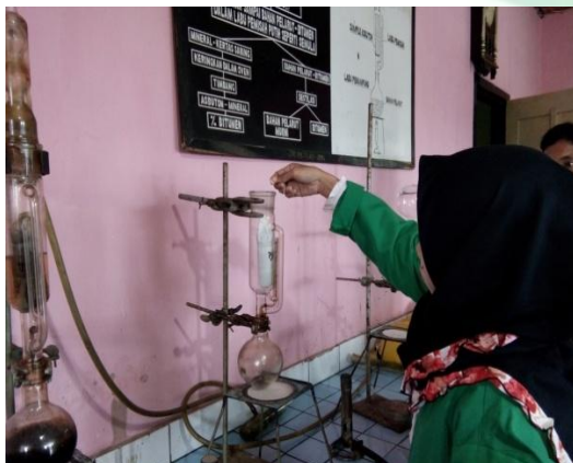
Pemasukan sampel aspal ke dalam tabung ekstraksi untuk ekstraksi kadar aspal
