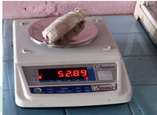
Penimbangan sampel aspal setelah pengeringan
