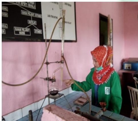
Ekstraksi kadar air sudah berwarna putih kekuningan
