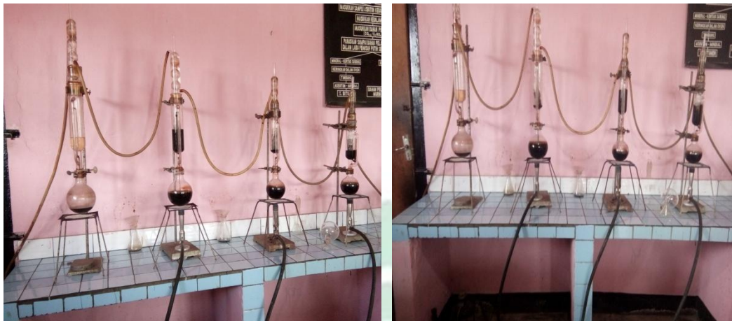
Proses ekstraksi kadar aspal pada pengujian I
