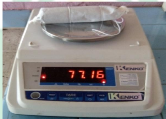
Penimbangan kertas saring + sampel sebelum ekstraksi kadar aspal.
