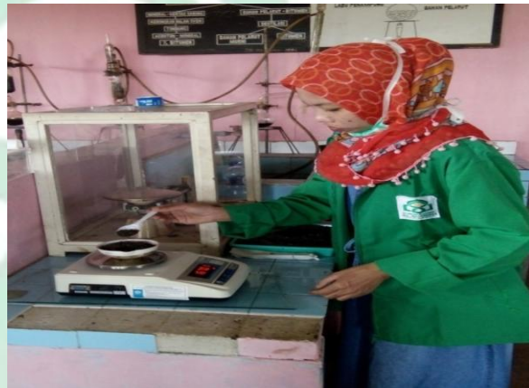
Memasukkan sampel dalam cawan
