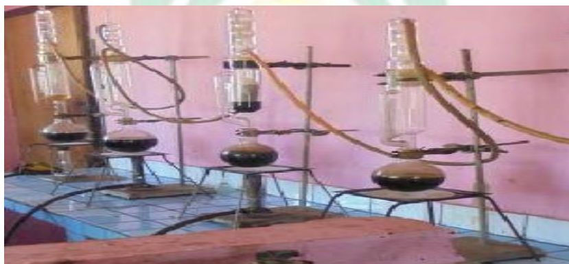
Proses ekstraksi kadar aspal pada pengujian II
