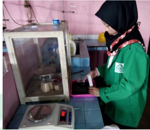
Memasukkan sampel aspal ke dalam kertas saring.
