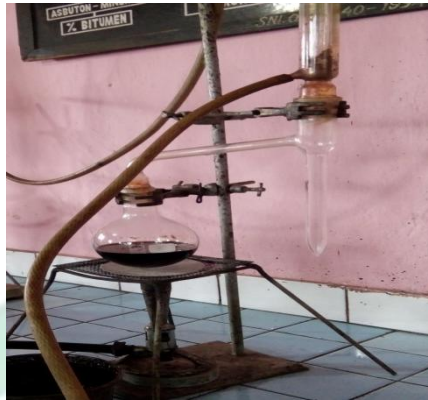
Memulai proses ekstraksi kadar air
