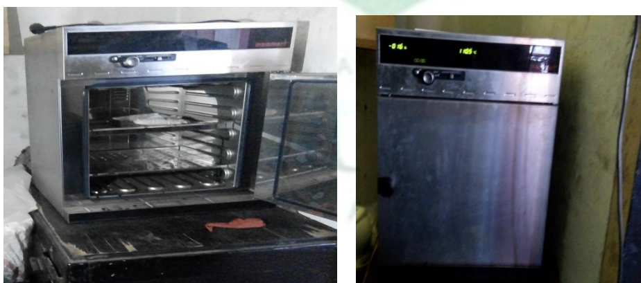
Proses pengeringan sampel setelah ekstraksi kadar aspal
