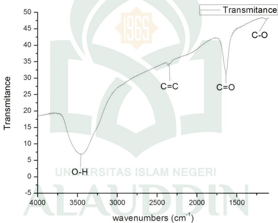
Gambar 4.9. Hasil karakterisasi FTIR C-Dots larutan gula pasir
