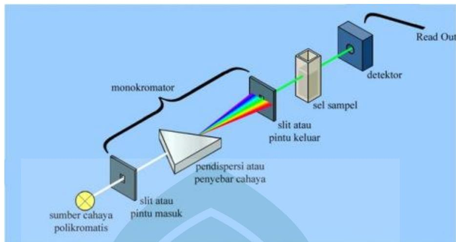
Gambar 2.6. Prinsip kerja spektrofotometer (Sumber: Underwood, 2002).
