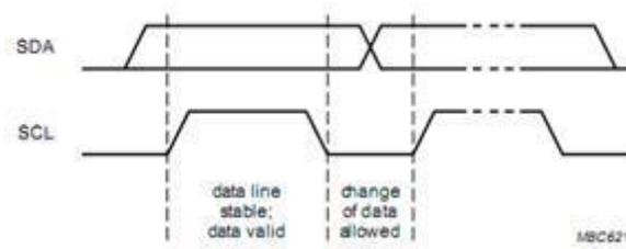
Gambar II.11. Transfer Bit pada I<sup>2</sup>C Bus
