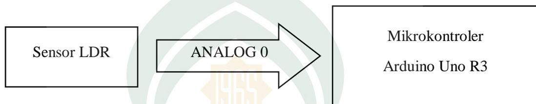
Gambar IV.7. Ilustrasi Sensor LDR.
