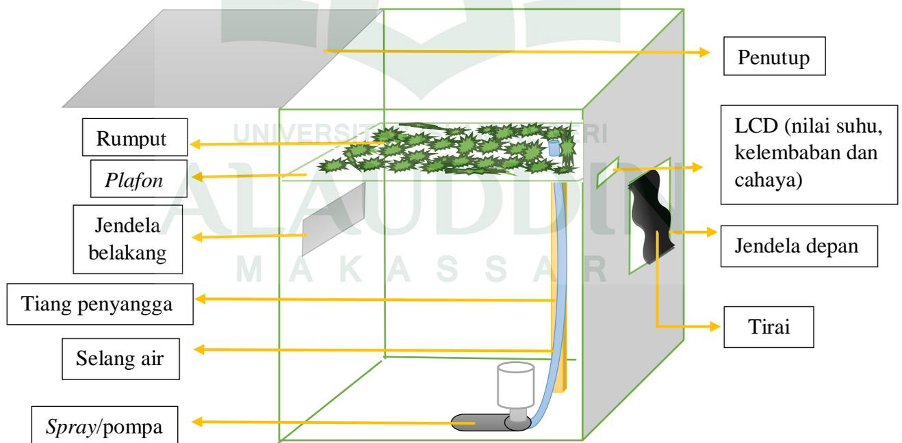
Gambar IV.5. Rangkaian Mekanik Box Prototype Burung Walet
