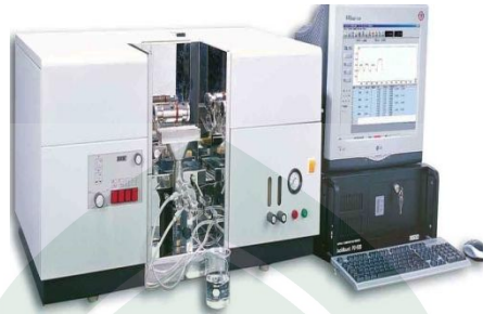
Gambar 2.7 :Rangkaian Alat Spektroskopis Serapan Atom (SSA) (sumber : https://www.google.com gambar alat instrumen AAS)
