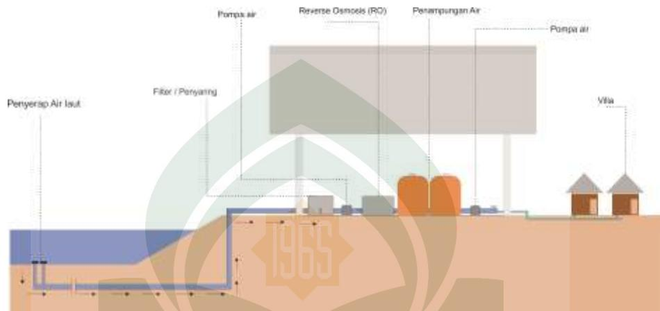
Gambar IV.25 Skema penyulingan air asin menjadi air tawar
