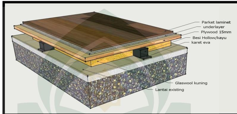
Gambar IV.12 (konsep lantai pada laboratorium)
