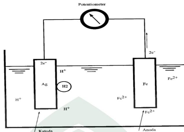
Gambar 2.2 Mekanisme terjadinya korosi (Sumber: Widharto, 1999).
