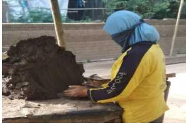
Gambar 4.6 Proses Pencetakan Batu Bata
