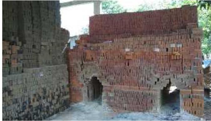
Gambar 4.10. Pembongkaran susunan batu bata yang sudah di bakar
