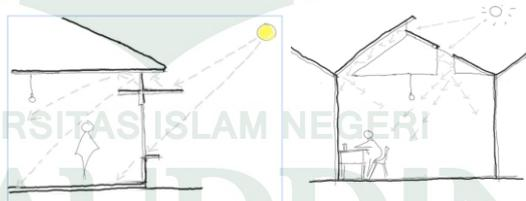
Gambar III.41. Sistem Pencahayaan Langsung dan Tidak Langsung
