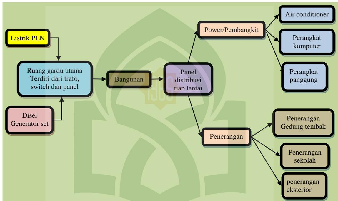
Gambar III.32 : Skema sistem jaringan listrik bangunan
