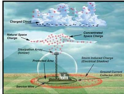
Gambar III.37. Penangkal petir radioaktif
