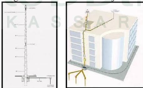
Gambar III.36. Penangkal petir pasif
