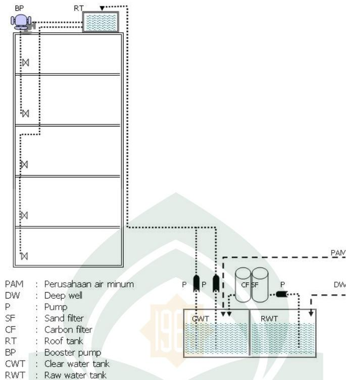
Gambar III.33: Skema Sistem Air Bersih Bangunan
