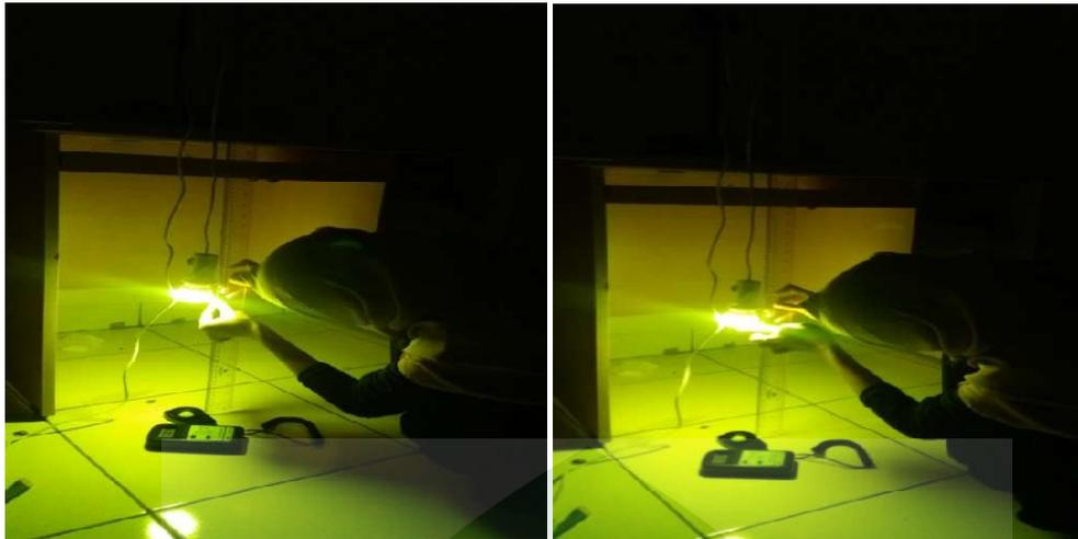
*Gambar 6.2.3 Set up Alat untuk Mengukur Luminesensi Lampu LED Warna Kuning.*
