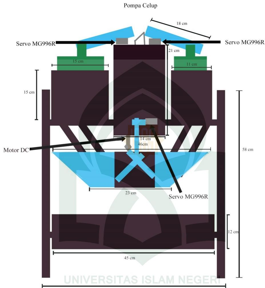
Gambar IV.4 Rancangan Keseluruhan Mekanika
