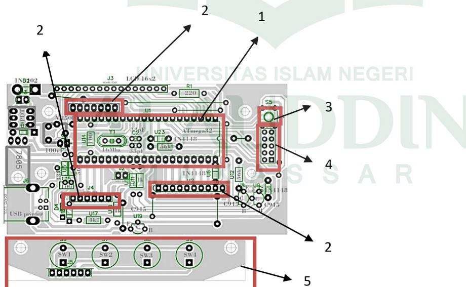
**Gambar IV.4** Rangkaian modul Mikrokontroler dan Button
