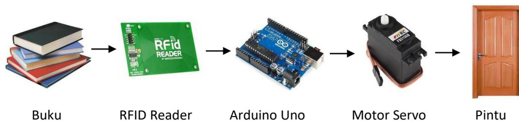
**Gambar IV.3** Desain Keseluruhan Alat
