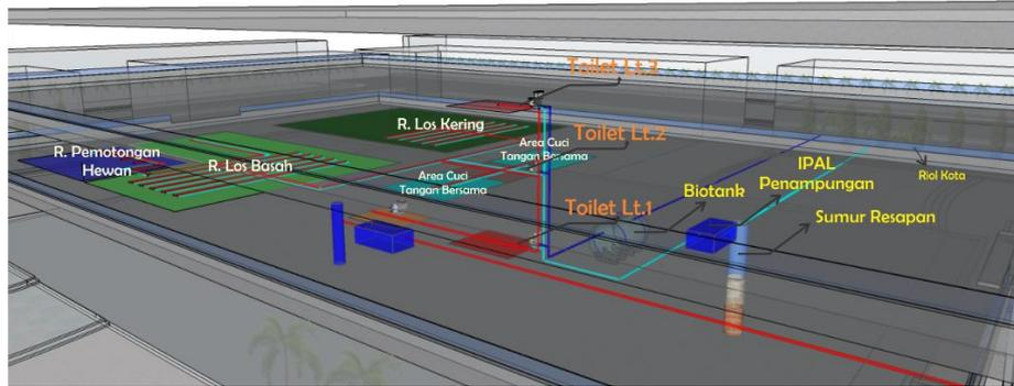
**Gambar 4.6** Pendekatan Perancangan Utilitas Air Kotor Pada Bangunan Pasar
