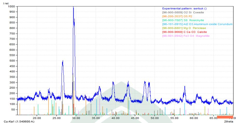
Gambar 4.9. Hubungan antara intensitas dan sudut  $2\theta$  pada sampel 7
