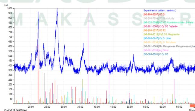
Gambar 4.2. Hubungan antara intensitas dan sudut  $2\theta$  pada sampel 1
