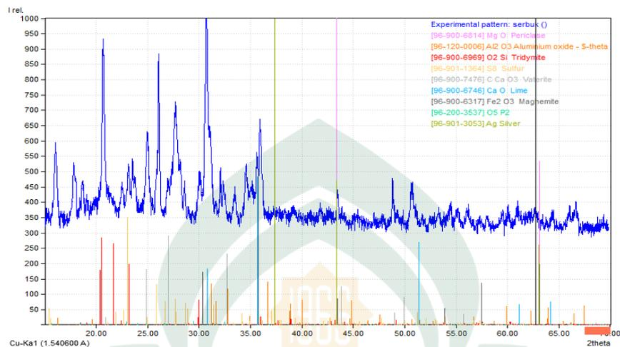
Gambar 4.4 Hubungan antara intensitas dan sudut  $2\theta$  pada sampel 3
