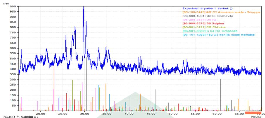
Gambar 4.6. Hubungan antara intensitas dan sudut  $2\theta$  pada sampel 5
