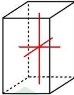
Gambar 2.9 Sistem *orthorhombic*
