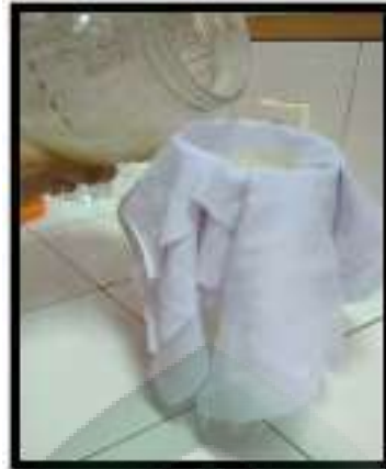
Gambar 15. Penyaringan hasil perendaman menggunakan kain flanel
