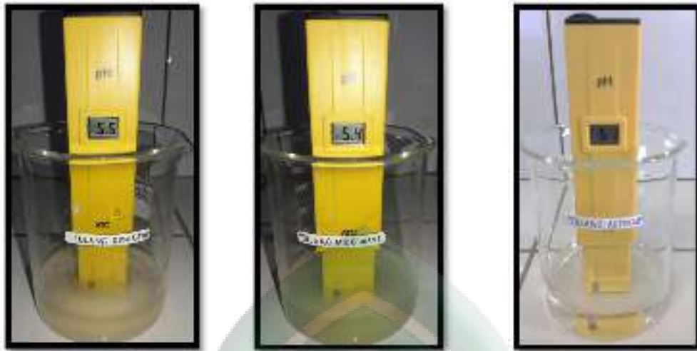
Gambar 40. Hasil pengukuran pH larutan gelatin yang direndam asam asetat 1 N dengan metode ekstraksi menggunakan alat (a) Sonikator (b) Microwave, dan (c) Autoklaf
