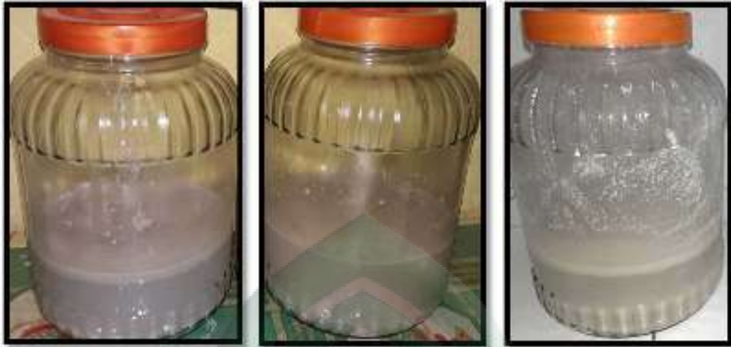
(a) (b) (c) Gambar 13. Perendaman tulang ikan bandeng dengan asam asetat 1 N menggunakan (a) Sonikator (b) Microwave, dan (c) Autoklaf
