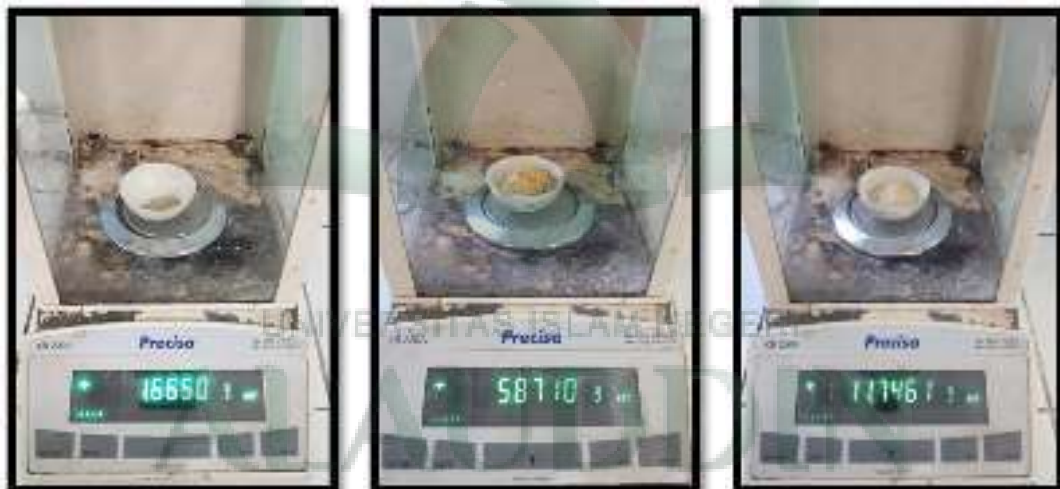
Gambar 37. Hasil penimbangan gelatin yang direndam NaOH (a) Konsentrasi 0,01 N, (b) Konsentrasi 0,1 N, dan (c) Konsentrasi 1 N
