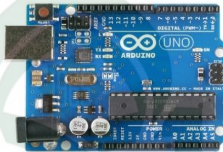
Gambar II.3 Arduino uno R3 (Yuwono M, 2015)
