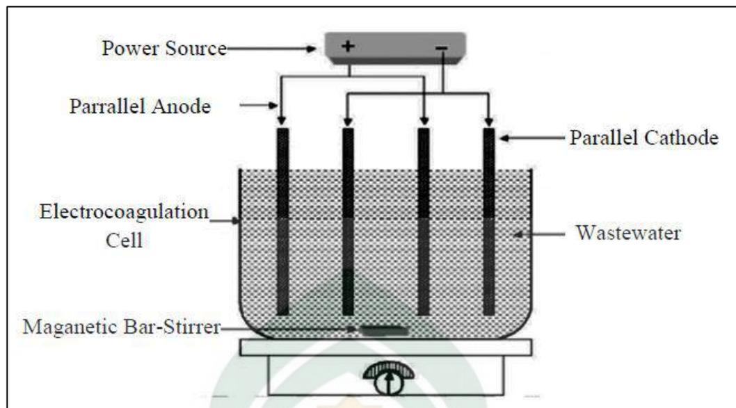
Gambar 2.2. Skema Alat Elektrokoagulasi.
