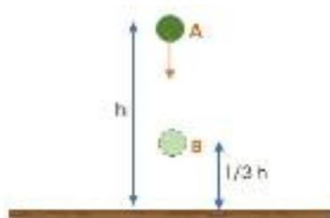
Sebuah benda jatuh bebas dari posisi A seperti pada gambar di atas. Hitunglah perbandingan energi potensial dan energi kinetik ketika sampai di B !
