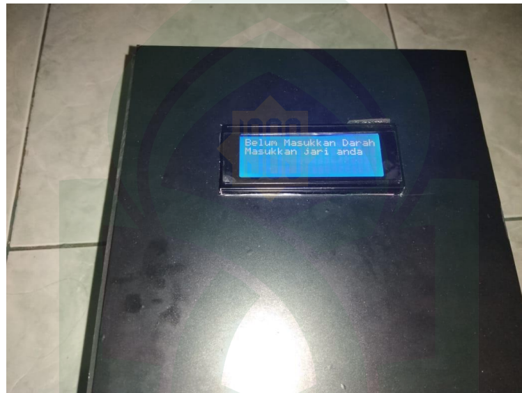
Gambar V.12 Kondisi Alat Pada saat belum di isi darah dan belum memasukkan jari ke sensor PPG
