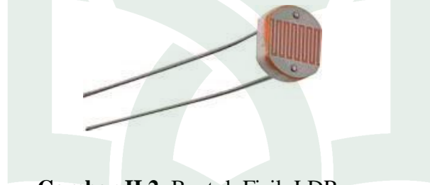
Gambar II.2. Bentuk Fisik LDR
