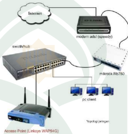
Gambar IV.30. Skema Jaringan WI-FI Sumber : www.forummikrotik.com
