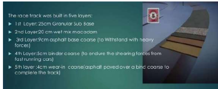
Gambar 2.2: Lapisan bahan penyusun Lintasan Sumber: http://sponsoring.alianz.com
