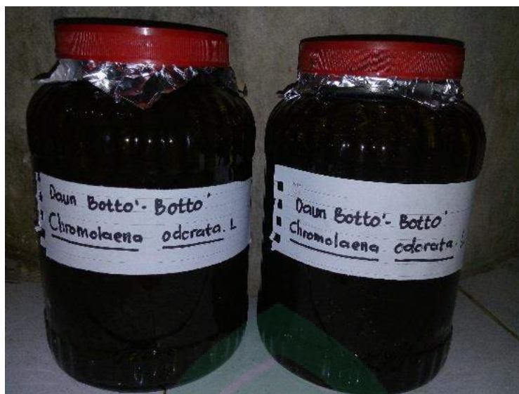
Gambar 5. Proses maserasi Daun botto'-botto ( Chromolaena odorata L.) dengan menggunakan pelarut n-Heksan
