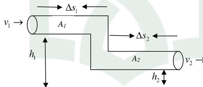
Gambar 2.2 Aliran fluida pada Luas penampang
