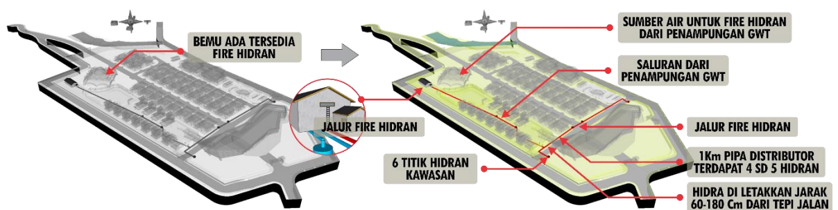
Gambar V. 17. Transformasi saluran fire hidran Sumber: Hasil desain, 24 mei 2019, 17.30 Wita
