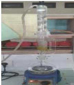
Soxhletasi dengan Menggunakan Pelarut Etanol ( C_2H_5OH ) 96% dan n-Heksan ( C_6H_{14} )
