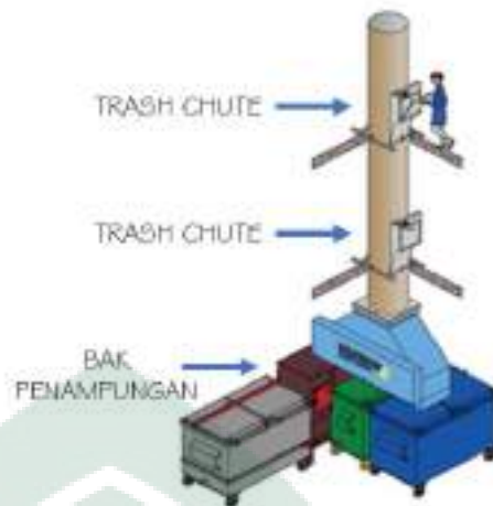
Gambar III. 29 Sistem Trash Chute Sumber : tocondonews.com, diakses oktober 2018
