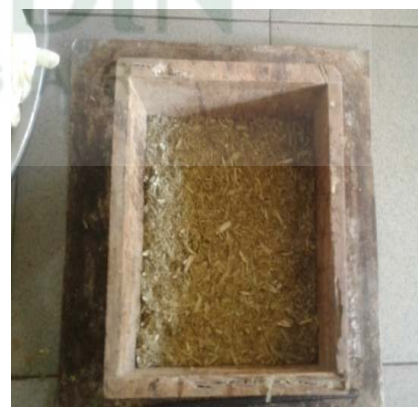
gambar 24: Sampel Yang Sudah Diratakan
