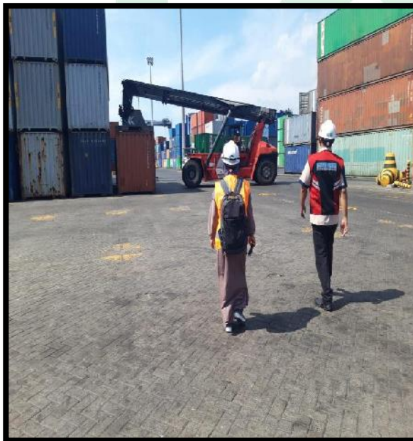
Gambar 3 Proses Pemindahan dan penumpukan kontainer menggunakan alat Reach Stacker
