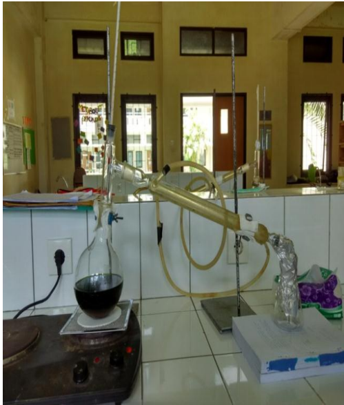
G. 28(a) rangkaian alat destilasi
