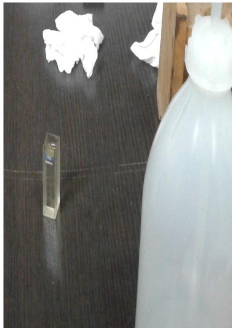
G. 62 cuvet berisi etanol digunakan sebagai pelarut dan pembanding
