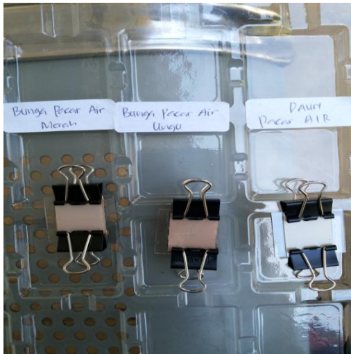
G. 60 sel yang telah ditetesi larutan elektrolit dan siap diuji kuat arus dan tegangannya
