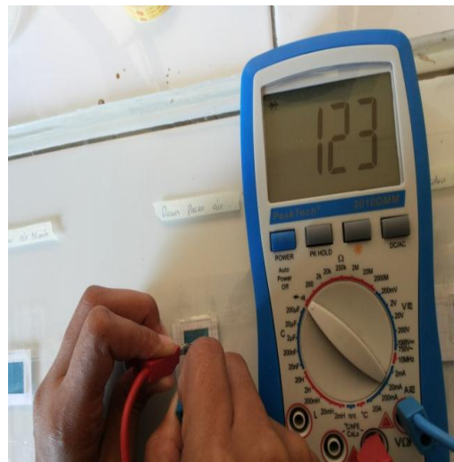
G.35 mengukur resistansi kaca untuk sampel daun pacar air
