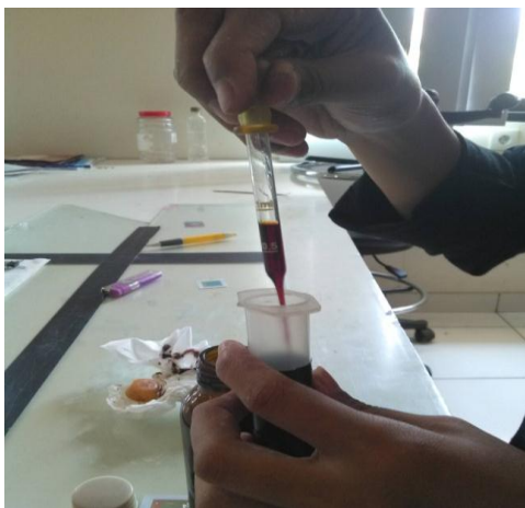
G. 58 memasukkan larutan iodine kedalam spoid yang berisi padatan KI kemudian di homogenkan
