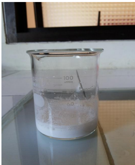
G.30 \text{TiO}_2 4 sendok sampel yang dilarutkan dalam etanol sebanyak 20
