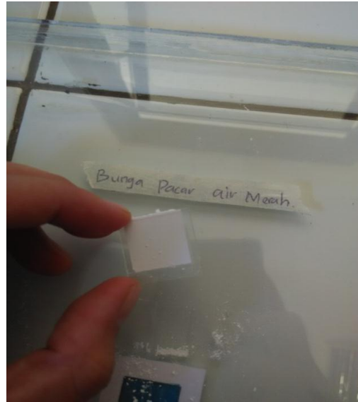
G. 39 Hasil deposisi pada kaca ITO untuk bunga pacar air merah
