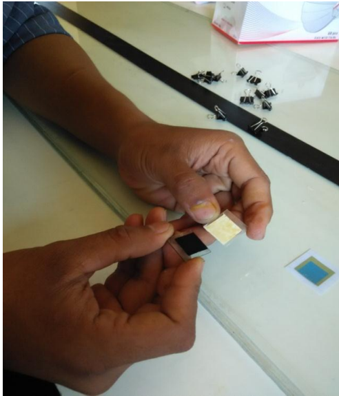
G. 53 Hasil elektroda karbon Kaca ITO dan elektroda kerja yang akan disusun
