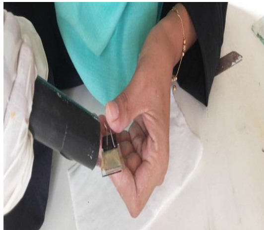
G. 59 penetesan larutan elektrolit pada kedua sisi
