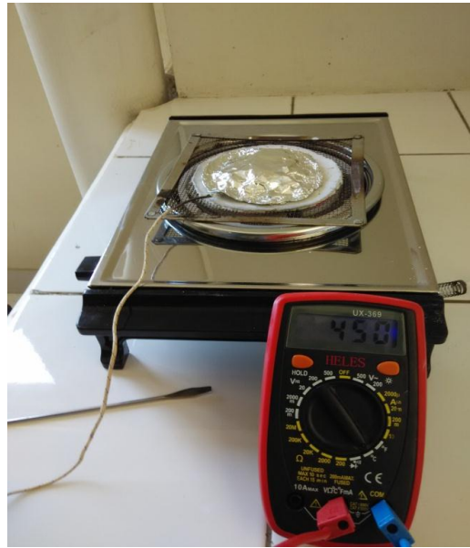
G. 42 hasil deposisi disintering dengan suhu 450°C selama 30 menit
