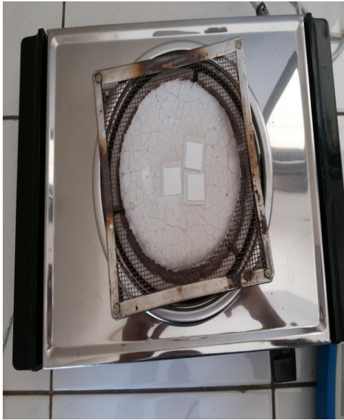
G. 41 hasil deposisi yang disintering
