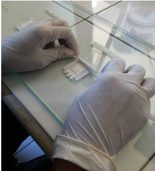
G. 38 pendeposisian \text{TiO}_2 pada Kaca ITO
