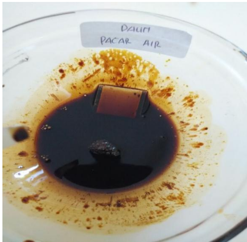
G. 45 kaca ITO yang direndam pada dye daun pacar air selama 24 jam
