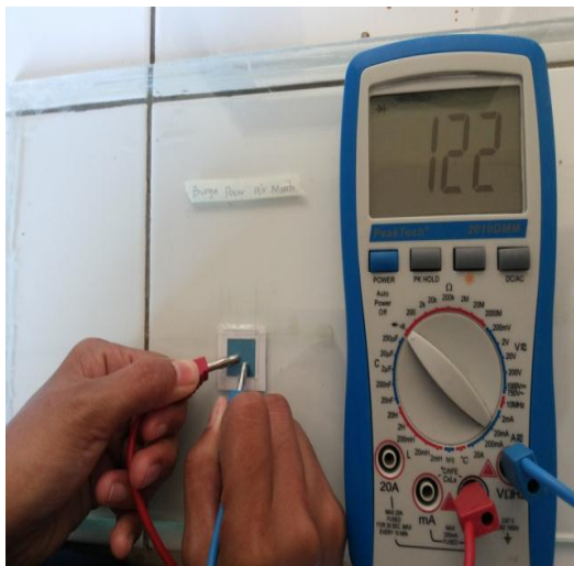
G.36 mengukur resistansi kaca untuk sampel bunga pacar air merah
