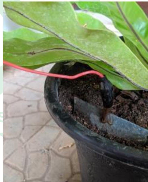
Gambar L.19 Penanaman elektroda sebagai katoda
