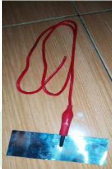
Gambar 4.2. Elektroda dihubungkan dengan kabel (Sumber : Dok Pribadi)
