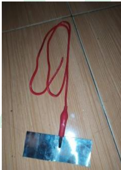
Gambar L.15 Meyabungkan kabel dengan elektroda
