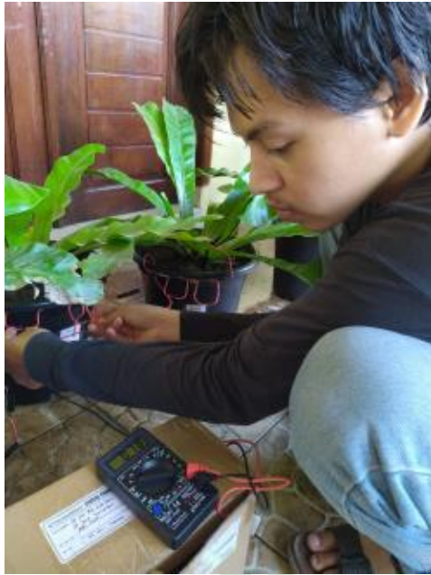
Gambar L.22 Mengukur arus dan tegangan Listrik
