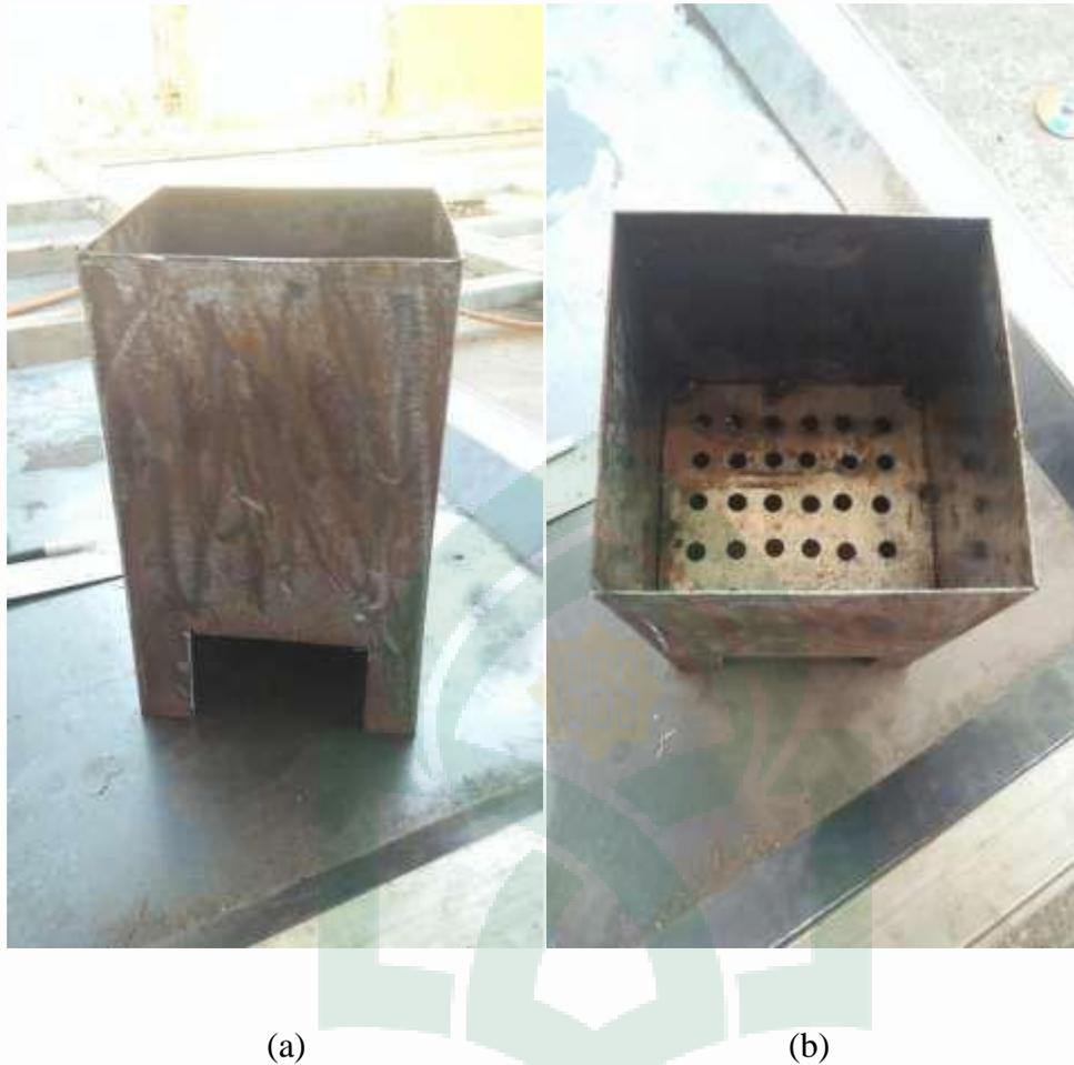
Gambar 4.1: Tempat pembakaran briket (a) tampak depan dan (b) tampak atas
