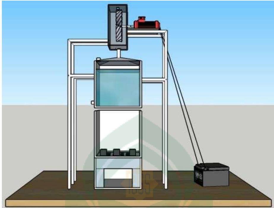
Gambar 3.2: Desain rancang bangun miniatur pembangkit listrik uap air tampak depan
