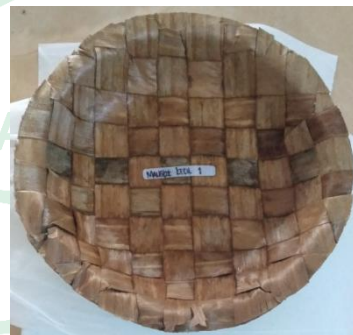
Gambar 4.50 Setelah di Uji Ketahanan wadah makanan Mangkok Kecil Anyaman terhadap suhu 80°C
