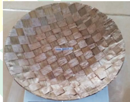
Gambar 4.48 Setelah di Uji Ketahanan wadah makanan Piring Besar Anyaman terhadap suhu 40°C
