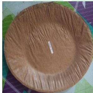
Gambar 4.17 Sebelum di Uji Ketahanan wadah terhadap suhu 40°C
