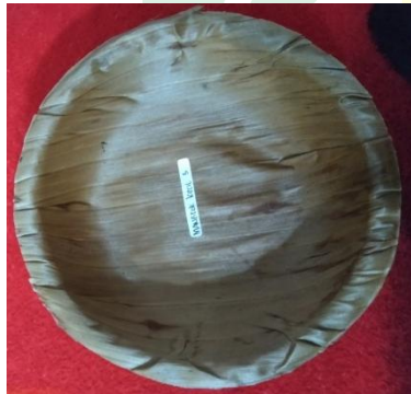
Gambar 4.23 Sebelum di Uji Ketahanan wadah terhadap suhu 40°C
