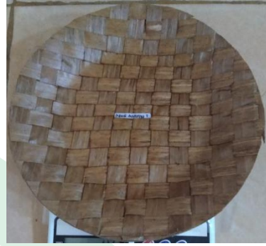
Gambar 4.46 Setelah di Uji Ketahanan wadah makanan Piring Besar Anyaman terhadap suhu 60°C
