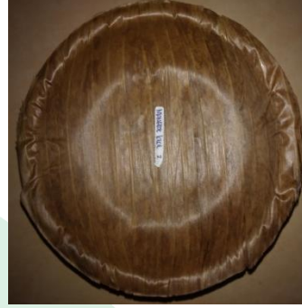
Gambar 4.22 Setelah di Uji Ketahanan wadah terhadap suhu 60°C
