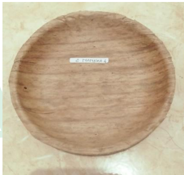
Gambar 4.25 Sebelum di Uji Ketahanan wadah terhadap suhu 80°C
