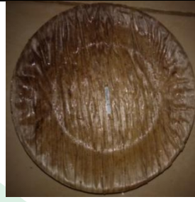
Gambar 4.16 Setelah di Uji Ketahanan wadah terhadap suhu 60°C
