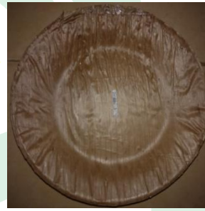
Gambar 4.18 Setelah di Uji Ketahanan wadah terhadap suhu 40°C
