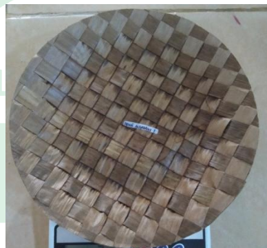
Gambar 4.44 Setelah di Uji Ketahanan wadah makanan Piring Besar Anyaman terhadap suhu 80°C
