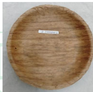
Gambar 4.26 Setelah di Uji Ketahanan wadah terhadap suhu 80°C
