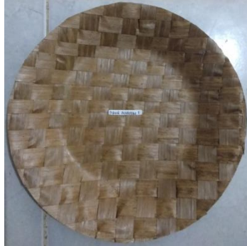
Gambar 4.45 Sebelum di Uji Ketahanan wadah makanan Piring Besar Anyaman terhadap suhu 60°C
