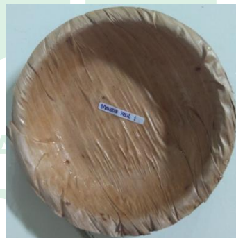
Gambar 4.20 Setelah di Uji Ketahanan wadah terhadap suhu 80°C
