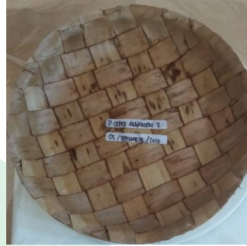
Gambar 4.40 Setelah di Uji Ketahanan wadah makanan Piring Kecil Anyaman terhadap suhu 60°C
