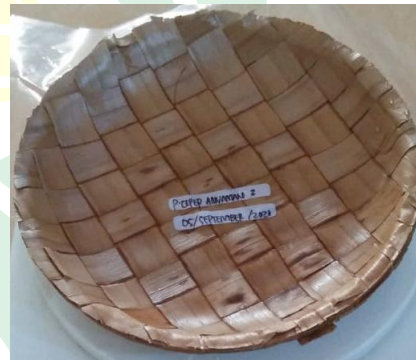
Gambar 4.42 Setelah di Uji Ketahanan wadah makanan Piring Kecil Anyaman terhadap suhu 40°C
