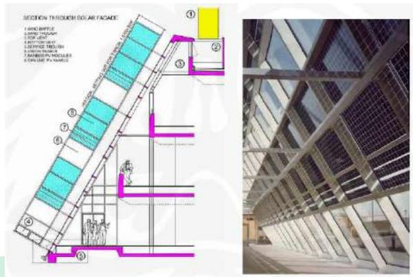
Gambar II. 18 Konstruksi Penopang Panel.
