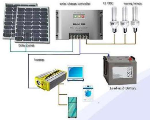
Gambar II.12 Skema Instalasi Listrik Panel Surya
