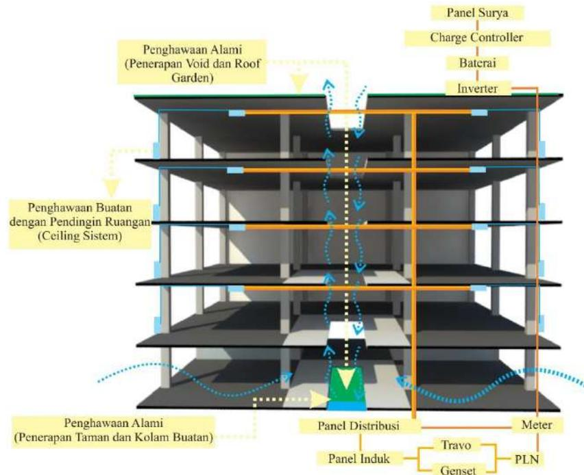
Gambar IV. 9 Sistem Penghawaan
