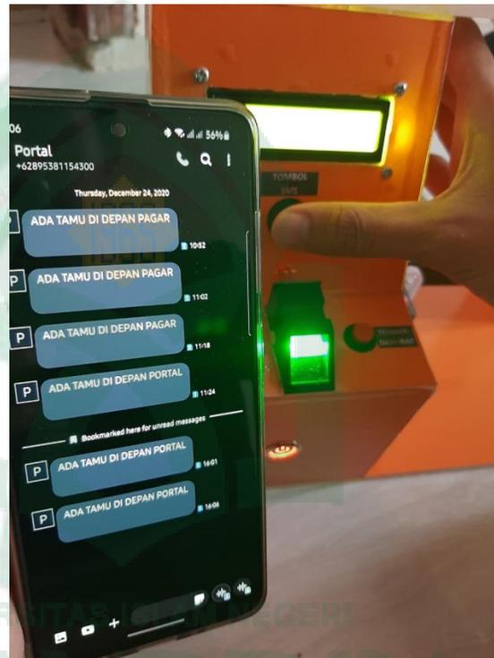
**Gambar V.17. Pengujian Push Button 2 dengan GSM800**
