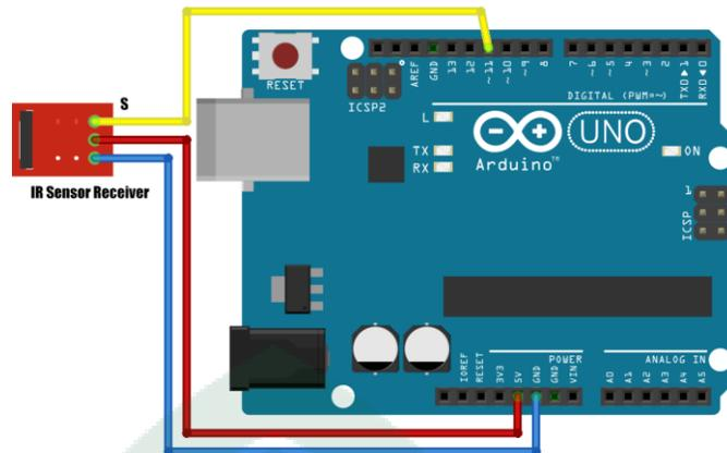
**Gambar IV.9. Rangkaian Infrared Sensor**
