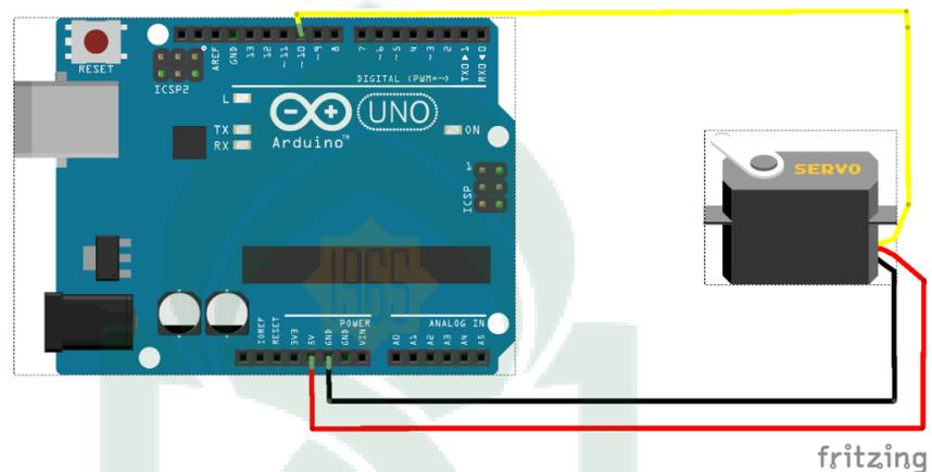
**Gambar IV.5. Rangkaian Motor Servo**
