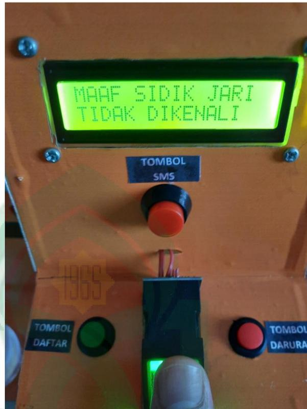
**Gambar V.4. Pengujian Jari yang Belum Terdaftar**
