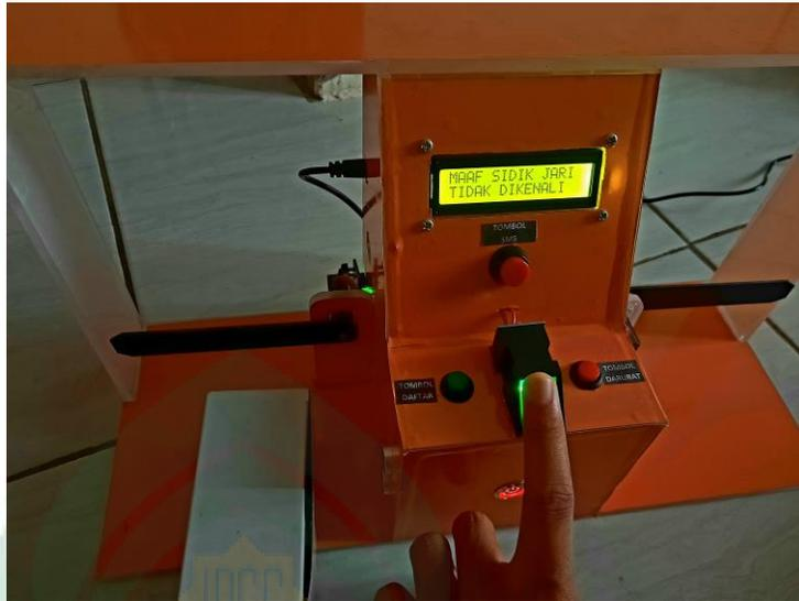
**Gambar V.12. Pengujian Fingerprint Sensor Dengan Motor Servo yang Tidak Sesuai**
