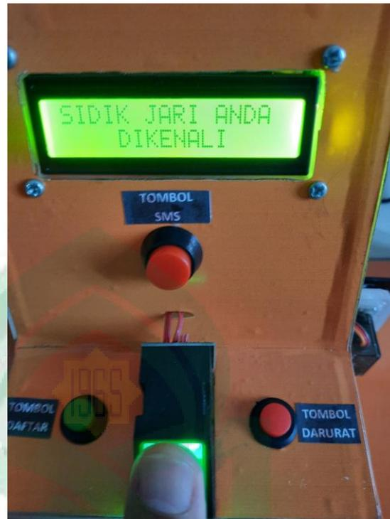
**Gambar V.3. Pengujian Jari yang Telah Terdaftar**
