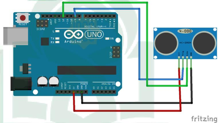
**Gambar IV.8. Rangkaian Ultrasonic Sensor**
