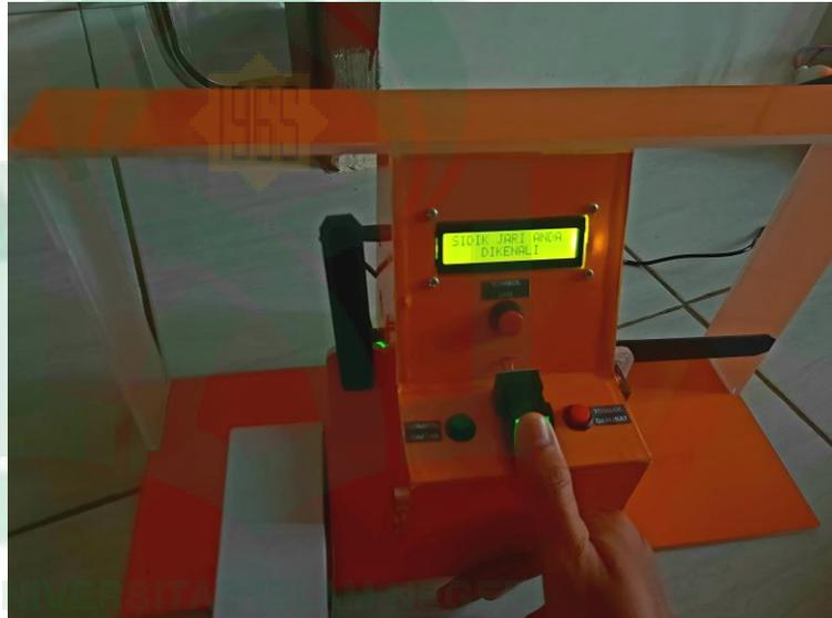
**Gambar V.11. Pengujian Fingerprint Sensor Dengan Motor Servo**
