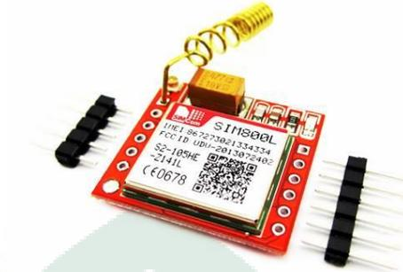
**Gambar II.3. Modul GSM SIM800**
