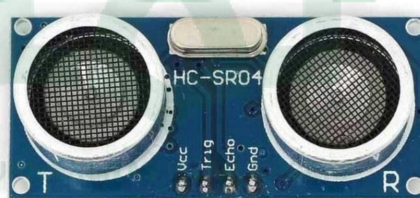
Gambar II.5. Sensor Ultrasonic
