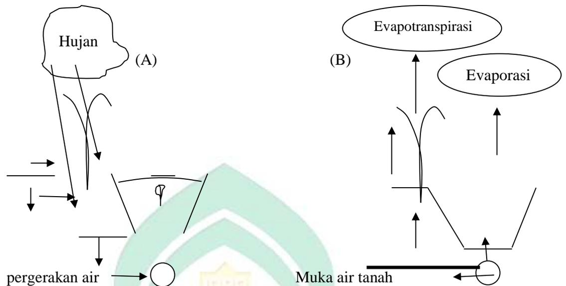
**Gambar 22.** Mekanisme pergerakan air pada sistem drainase bawah tanah opsi retensi air, dimana kondisi (A) adalah retensi air hujan, (B) adalah pemanfaatan air kapiler (sub-irigasi)
