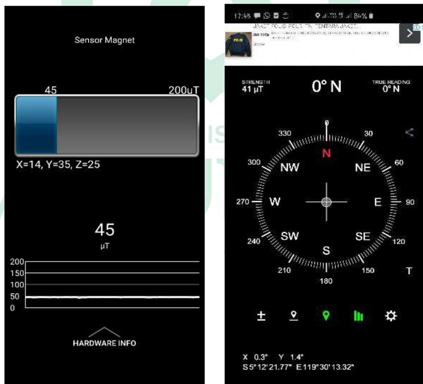
Setelah melakukan pengukuran medan magnet pada tempat terbuka dan tempat tertutup, selanjutnya penulis akan menguji kinerja kompas apa bila terdapat benda yang mengandung magnet atau besi didekat *smartphone*.
