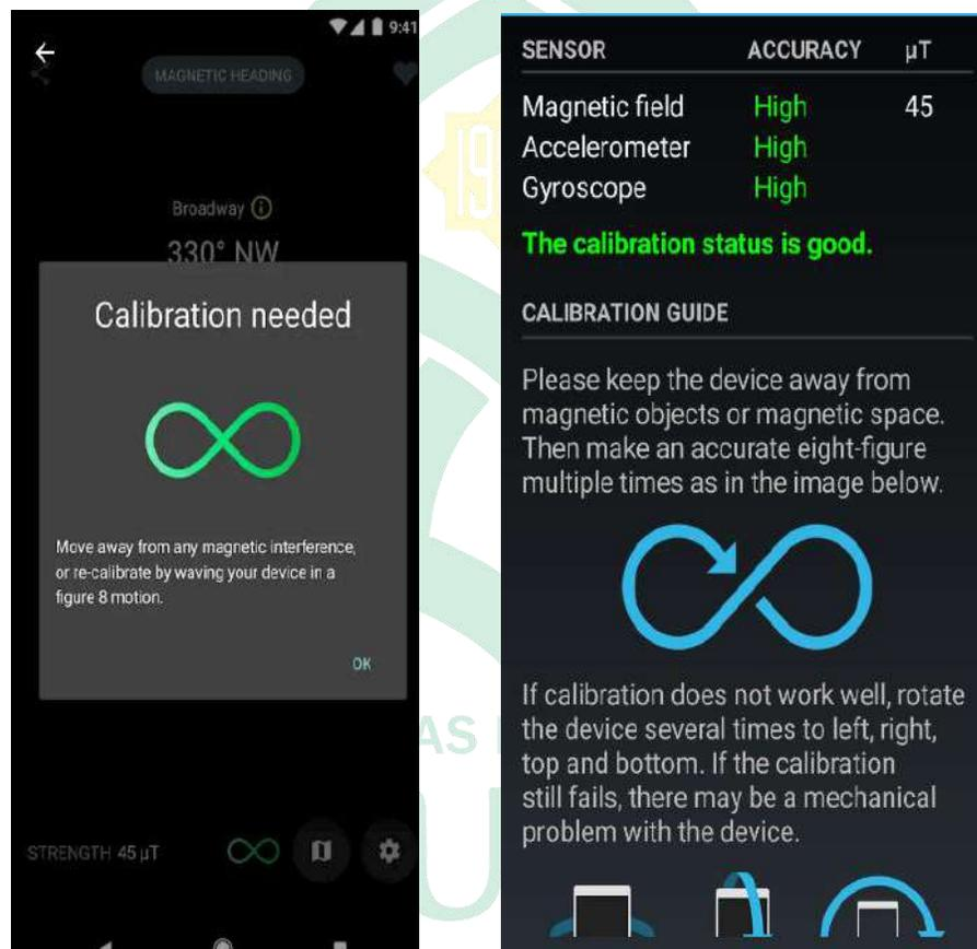
Setelah selesai melakukan kalibrasi, sensor magnet, akselerometer, dan sensor giroskop akan berkerja dengan baik dengan tingkat keakuratan yang tinggi, seperti yang ditampilkan pada gambar diatas.
