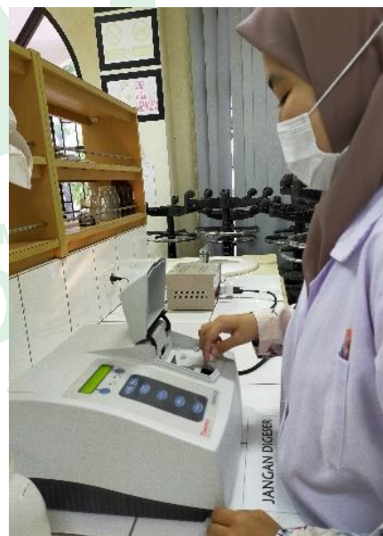
Diukur dengan spektrofotometer UV-Vis pada panjang gelombang 540 nm
