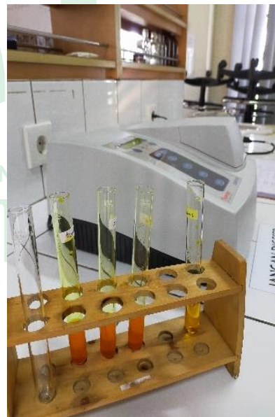
Diukur dengan spektrofotometer UV-Vis pada panjang gelombang 540 nm
