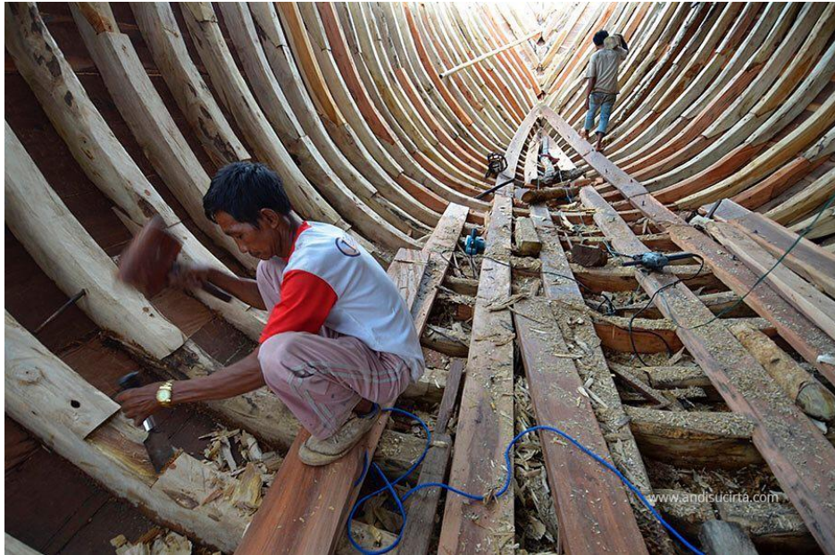
Foto Proses Penyambungan Lunas Perahu atau Proses Pembentukan Badan Perahu
