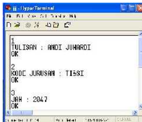
Gambar V.6. Komunikasi Serial pada Mikrokontroler dengan Fasilitas HyperTerminal
