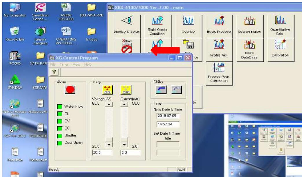
Pilih XG Control Program untuk pengecekan kondisi alat dalam keadaan baik.
