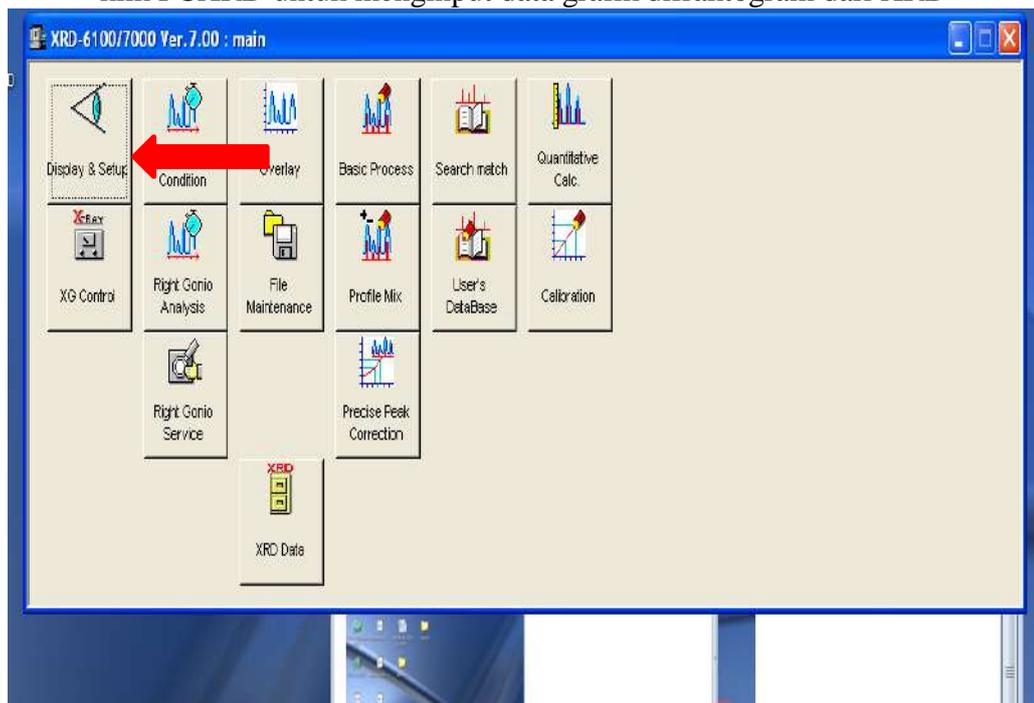
Klik Display & setup untuk mengecek XRD sudah terhubung dengan komputer.
