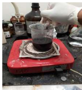
Melarutkan abu tongkol jagung dengan HCl 2N
