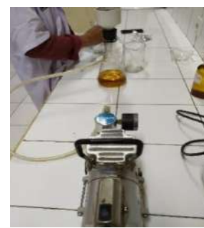
Menyaring dengan penyaringan bunhner
