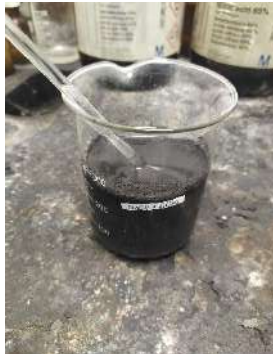
Melarutkan silika dengan NaOH
