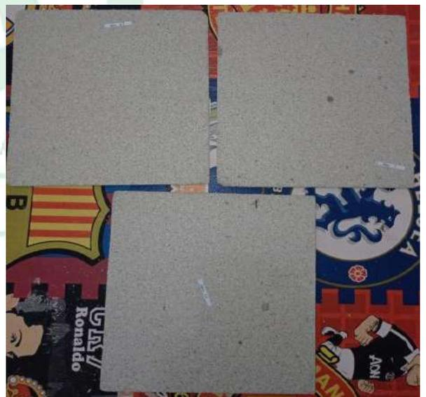
Gambar 2.12: Sampel yang telah dikeluarkan di *hotpress*
