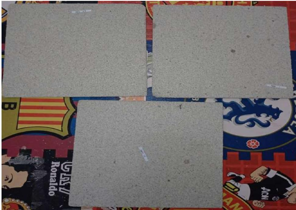
Gambar 4.1: Sampel Cacahan Halus dengan Variasi Ketebalan (a) 0,70 cm, (b) 1,00 cm, dan (c) 1,20 cm.
