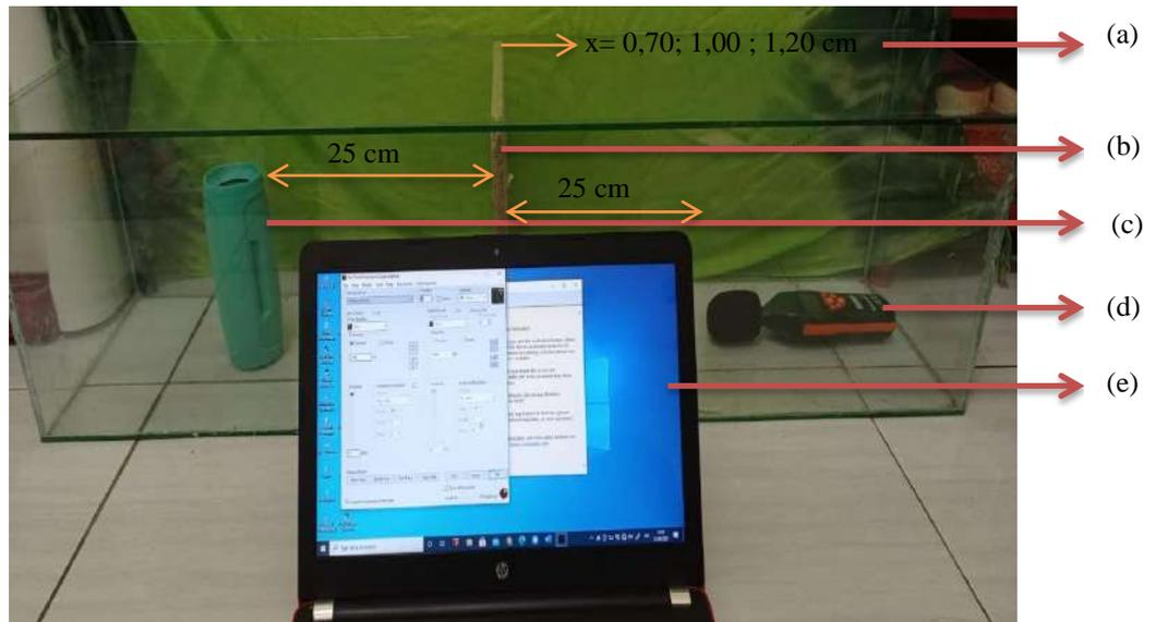
Gambar 4.4: Posisi Pengukuran Nilai Intensitas Bunyi pada Sampel
