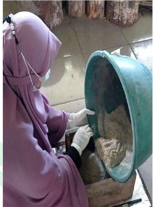
Gambar 2.10: Memasukkan bahan ke dalam cetakan
