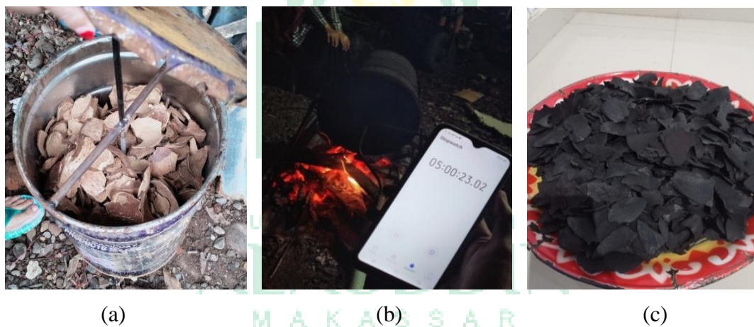
Gambar 4.2: Proses Karbonisasi (a) Sampel Tempurung Kelapa; (b) Proses Pengarangan Sampel Tempurung Kelapa; (c) Hasil Pengarangan Sampel Tempurung Kelapa
