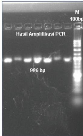
**Gambar 10.** Hasil Elektroforesis gel agarose 2% Isolat L2a, L3a dan L5a menunjukkan adanya amplifikasi pada 996 bp.
