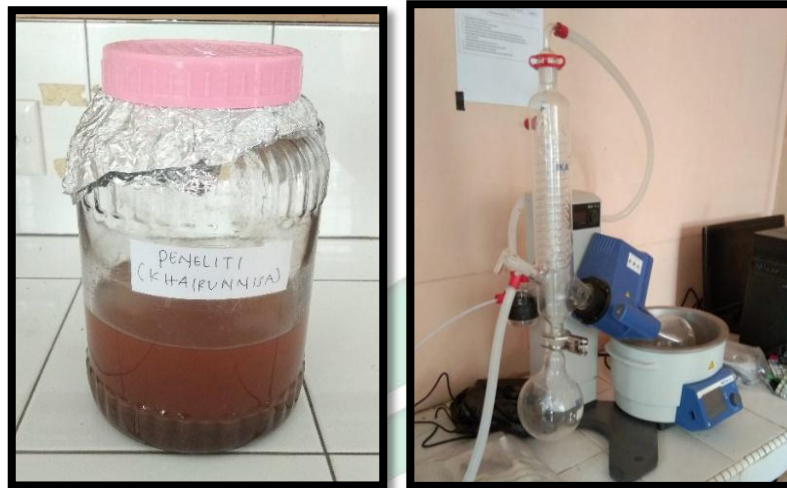
Gambar 14. Ekstraksi Sampel dengan Metode Maserasi
