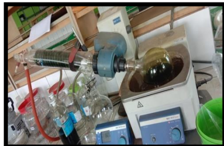
Gambar 8. Proses penguapan filtrat etanol dengan rotary evaporator
