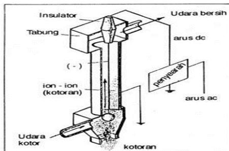
**Gambar 10.4:** Alat Pengendap Elektrostatik (Wardhana, 2001)
