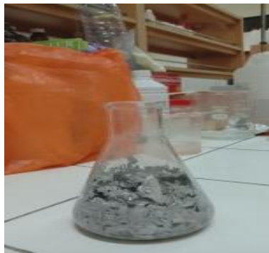
Melarutkan dengan NaOH
